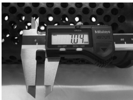
ストレーナー穴の計測 (写真 9)
