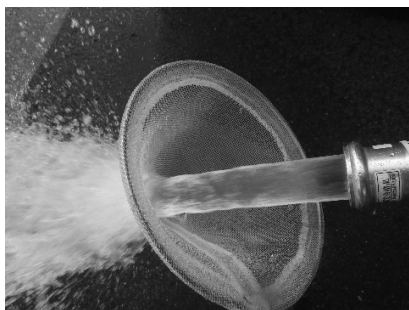
網目極小ネットで防火井戸水をろ過 (写真5)
